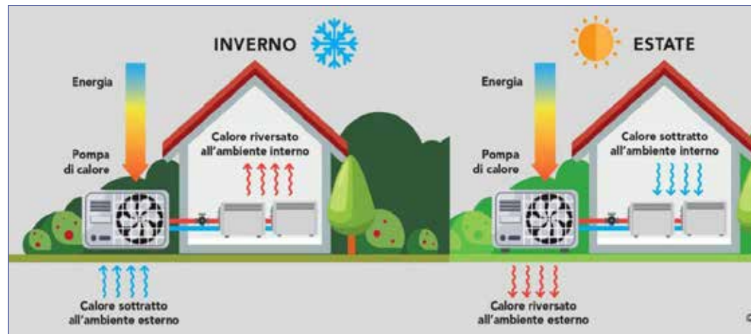
Come lavora una pompa di calore reversibile
